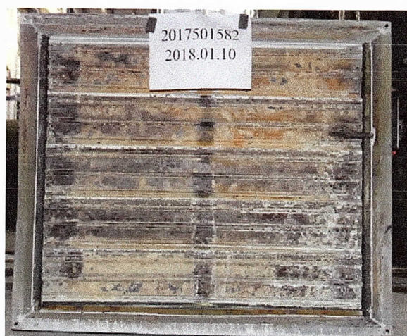
照片2 耐火性能试验结束时试件情况
