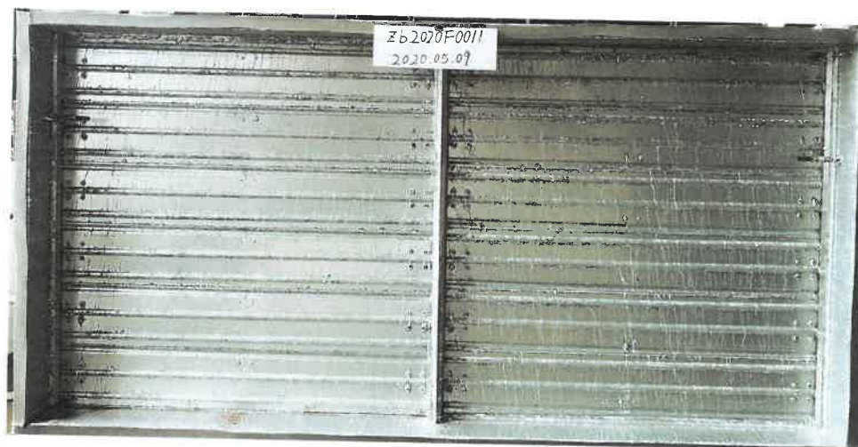
照片 1 耐火性能试验前试件情况
