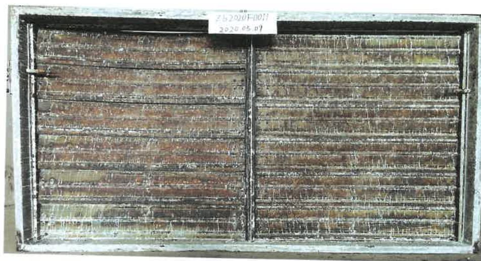
照片 2 耐火性能试验结束时试件情况
