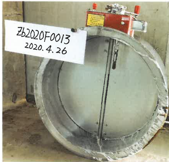
照片 1 耐火性能试验前试件情况
