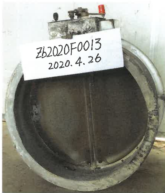
照片 2 耐火性能试验结束时试件情况
